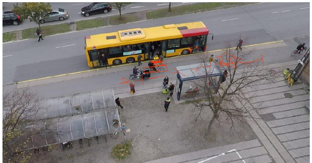
Figur 54 Resultatet af udpegningen for den sydlige side for morgenperioden 08:00-09:00, med TTC 0,15s og min. hastighedsforskel mellem trafikanterne på 18 km/t.
