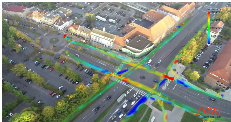
Figur 11 Oversigt over gennemsnitlige tangentielle accelerationer (heatmap over hastighedsændringer i bevægelsesretningen, opbremsninger/fartforøgelse) for cykler i morgenperioden 08:21-08:41. Blå farve indikerer opbremsninger, mens rød farve indikerer fartforøgelse.
