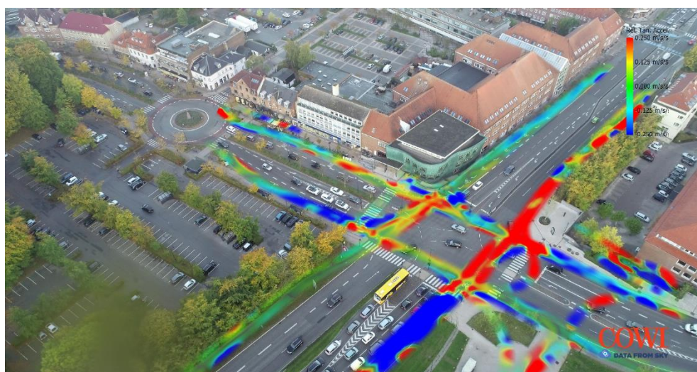
Figur 9 Oversigt over gennemsnitlige tangentielle accelerationer (heatmap over hastighedsændringer i bevægelsesretningen, opbremsninger/fartforøgelse) for cykler i morgenperioden 07:16-07:36. Blå farve indikerer opbremsninger, mens rød farve indikerer fartforøgelse.
