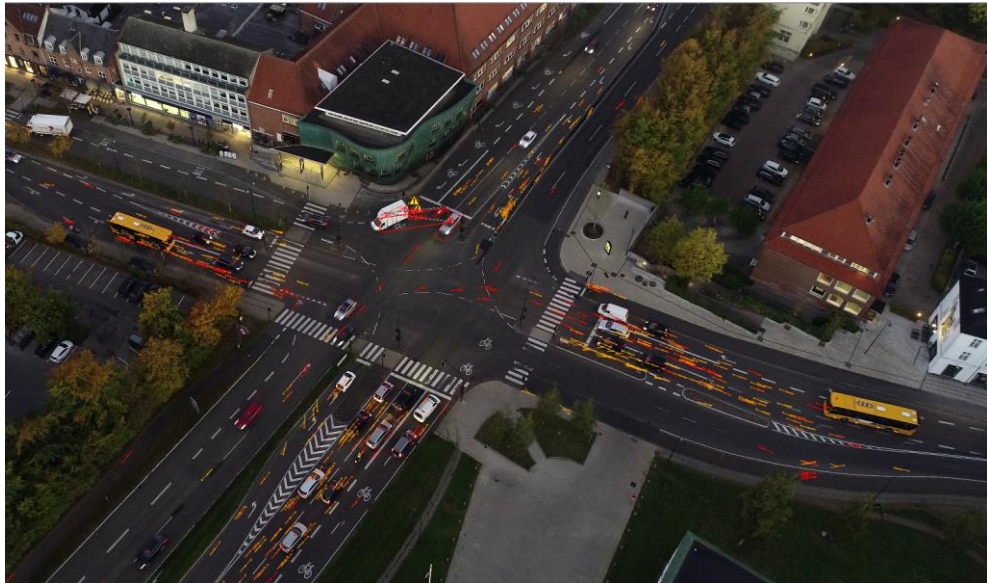
Figur 20 Resultatet af udpegningen for periode 1, med TTC 2s og min. hastighedsforskelle mellem trafikanterne på 5 km/t. De alvorligste udpegninger fremgår med rødt mens de øvrige udpegninger fremgår med orange.
