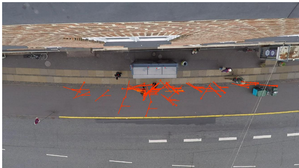
Figur 58 Resultatet af udpegningen for den sydlige side for eftermiddagsperioden 16:00-17:00, med TTC 0,15s og en minimums-hastighedsforskel mellem trafikanterne på 20 km/t.
