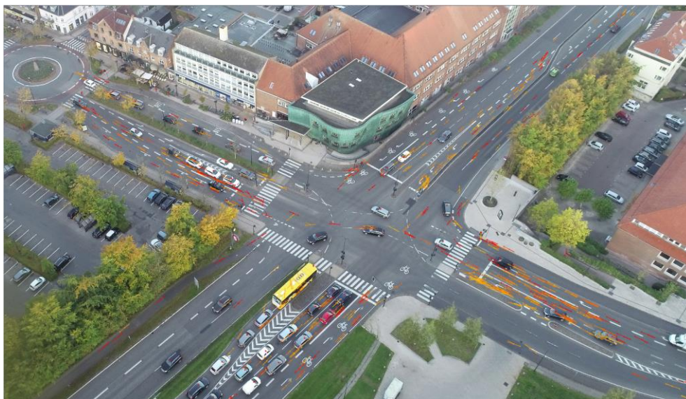
Figur 22 Resultatet af udpegningen for periode 2, med TTC 2s og min. hastighedsforskelle mellem trafikanterne på 5 km/t. De alvorligste udpegninger fremgår med rødt mens de øvrige udpegninger fremgår med orange.
