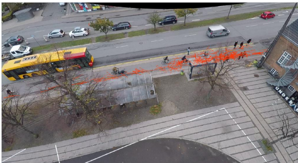
Figur 53 Resultatet af udpegningen for den sydlige side for analyseperioden som helhed, med TTC 0,15s og min. hastighedsforskel mellem trafikanterne på 18 km/t.
