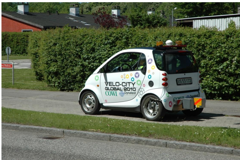
Figur 21 Hele ruten er gennemkørt med en målebil med laserscanningsudstyr til at måle huller og buler i belægningen.
