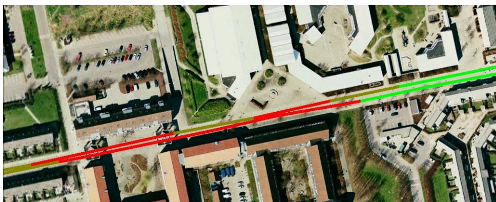
Eksempel fra jævnhedsmåling på Albertslundruten før forbedringer. Lys grøn angiver strækninger med målt BPI under 15. Olivengrøn angiver BPI mellem 15 og 20. Rød angiver BPI over 20.
