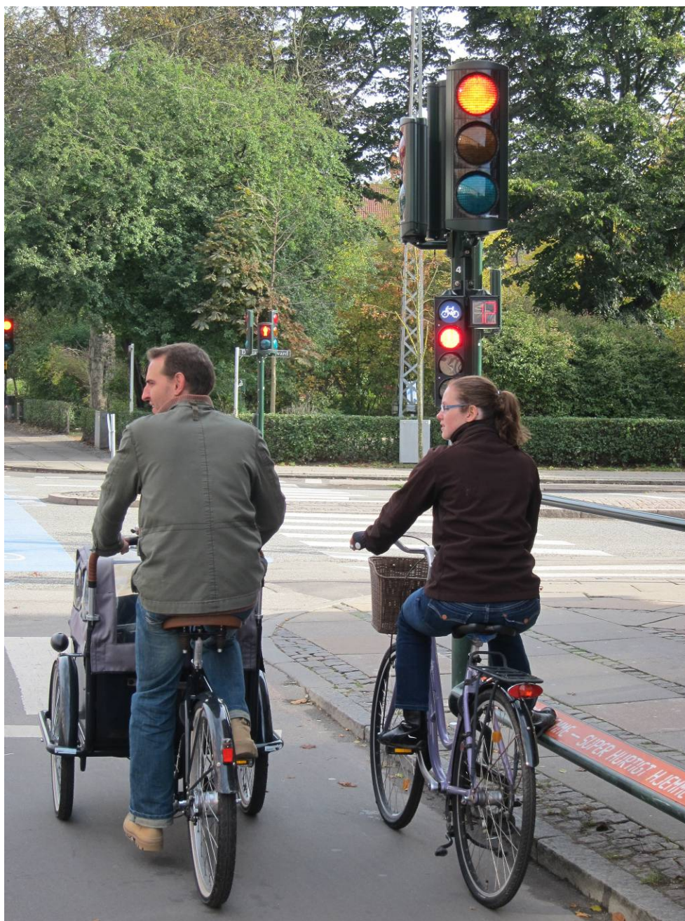
Eksempel fra Albertslundruten (Frederiksberg Kommune) på indsats i et signalkryds - nedtællingssignal og komfort tiltag med fodhviler.
