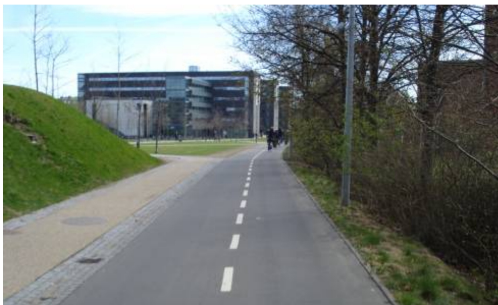
Eksempel på adskillelse mellem cyklister og fodgængere med chaussestensrende (Frederiksberg Kommune).
