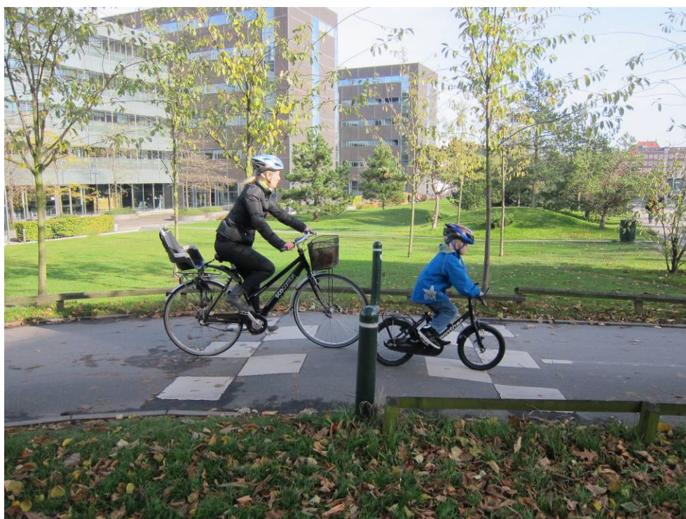
Eksempel på bump på cykelsti (Frederiksberg Kommune).
